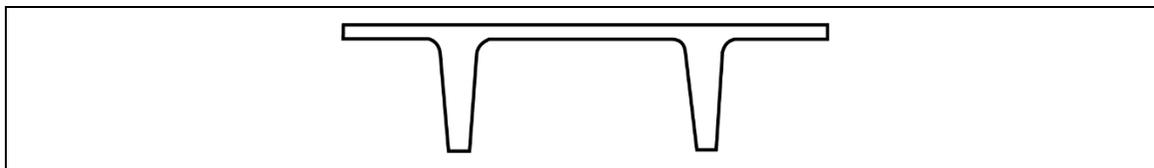
Figura A-1. Ejemplo de un bloque de hormigón doble T
